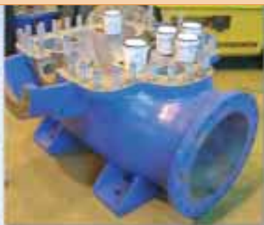
Рис.2: Поверхность подвергнута абразивной обработке до достижения шероховатости 75 мкм
